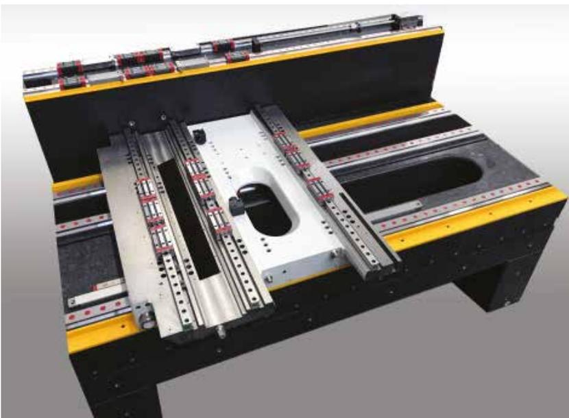
Sia l'asse X che Z scorrono su una tripla guida lineare con pattini a ricircolo di rulli, movimentati da motori lineari di ultima generazione e controllati da righe ottiche assolute pressurizzate. Nonostante le dimensioni di **X500**, la rigidità del movimento è da primato!
